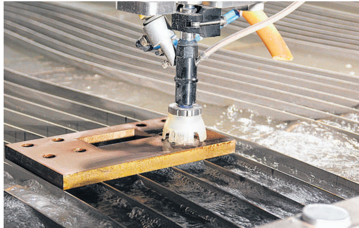
Der Schneidekopf fährt über das Werkstück, das auf das Wasserbecken aufgelegt ist. Mit einem Druck von 4000 bar wird dann ein meistens mit Sand vermischter Wasserstrahl erzeugt, der das Material mühelos durchschneidet. FOTOS (3): HARTMUT BREYER
